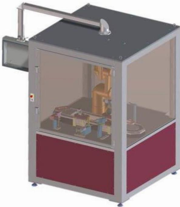
**Montagezellen von D+P** bieten größtmögliche Flexibilität. Durch die stabile und standardisierte Konstruktion, ist in der Zelle Platz für unterschiedlichste Prozesseinheiten. Die Zelle ist zudem beliebig erweiterbar, um viele Einsatzgebiete abdecken zu können.
